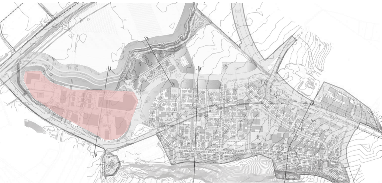
שוחות שיקוע במגרשי תעשייה ותעסוקה על מנת לטפל באיכות המים לפני ההזרמה לנחל
