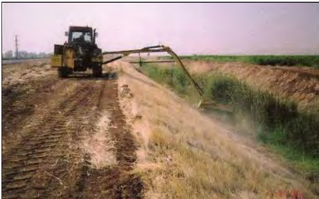
תמונה 1: כיסוח מכאני בנחל צבאים (אגן ניקוז נחל יששכר) בעזרת זרוע הידראולית (מתוך תה"ל, 2000).
