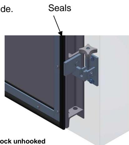
Fig. 1.1.3.2 Lock unhooked
