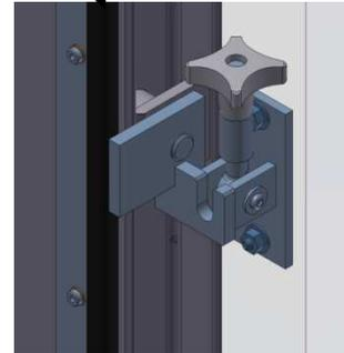
Fig. 2.1.3.2 Lock unhooked
