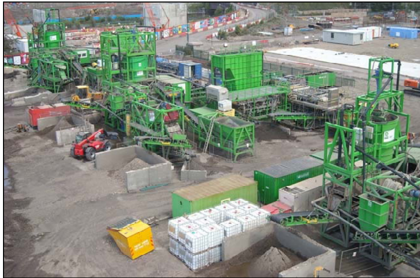
תמונה 29 – דוגמא של פרויקט הפרדת פרקציות והוצאת מים מסדימנטים וקרקע מזוהמת בכפר האולימפי בלונדון. פתרון הקצה במקרה זה – מטמנה.
