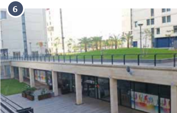
הצללה מבנית במעונות הסטודנטים באוניברסיטת תל אביב, כולל גג ירוק אינטגרטיבי מעל | התצלום באדיבות רוני בנין, גנרון
